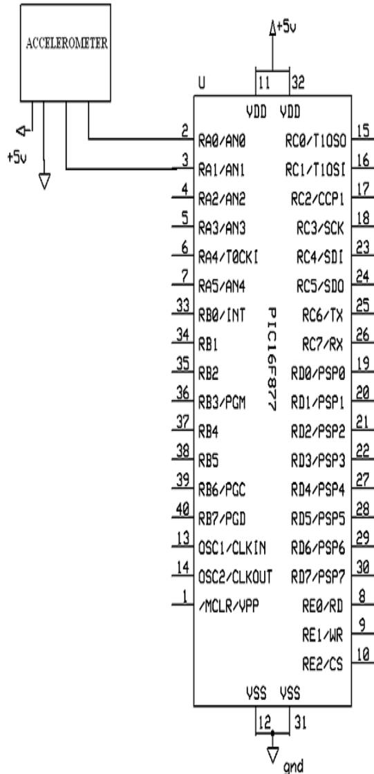
**ACCELEROMETER INTERFACING WITH MICRO CONTROLLER**
